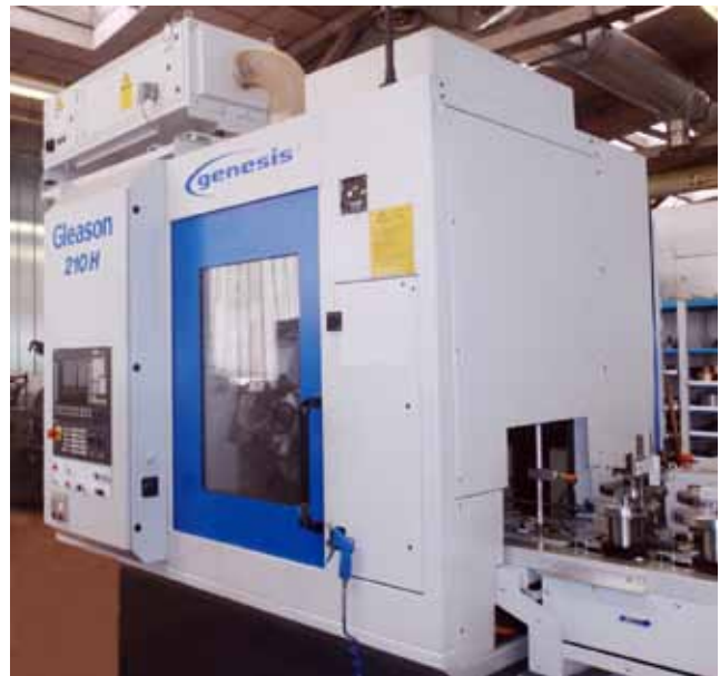
Bild: Gleason Pfauter 210 H Genesis Abwälzfräsen mit DiaGrind 535/15
