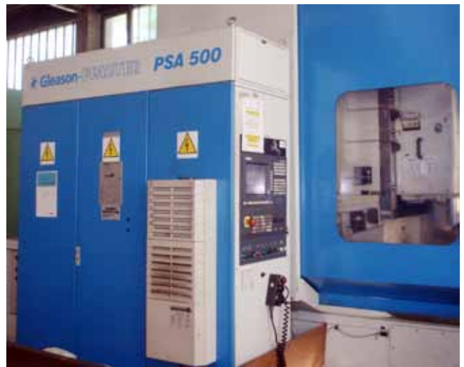
Bild: Gleason Pfauter PSA 500 Zahnradstossen mit DiaGrind 535/15
