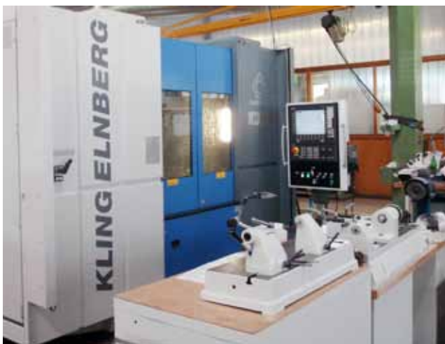
Bild: Klingelberg H 10 Verzahnungsschleifen mit DiaGrind 535/15
